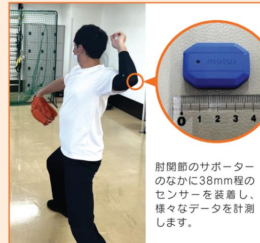
肘関節のサポーターのなかに38mm程のセンサーを装着し、様々なデータを計測します。
